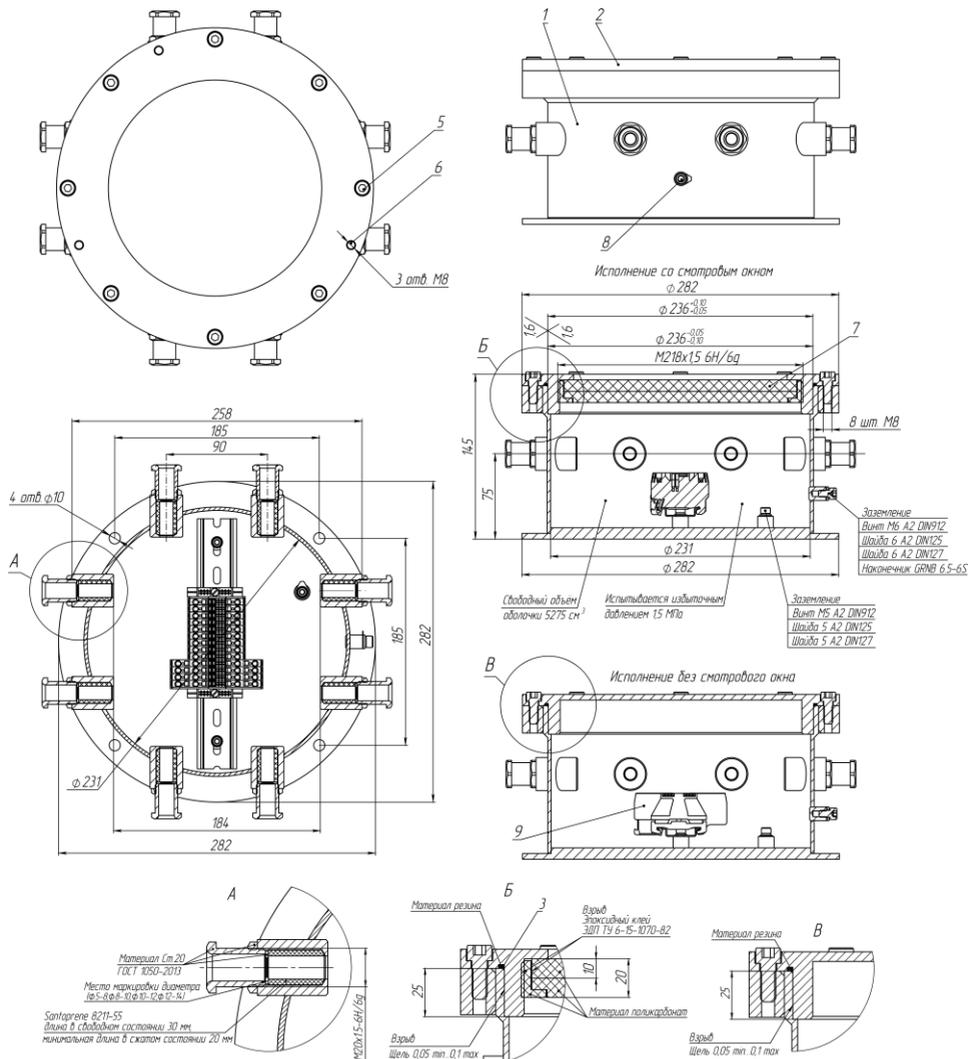
1 – корпус; 2 – крышка; 3 – уплотнительное кольцо крышки; 5 – винты М8х20 (8 шт) крепления крышки; 6 – отверстия М8 (3 шт) для демонтажа крышки; 7 – смотровое окно (опция); 8 – внешний винт М6х10 заземления; 9 – клеммный блок (показан для примера, может отличаться в выбранной модификации); кабельные вводы показаны для примера.
