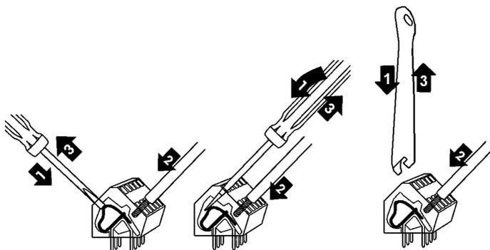
Для подключения проводников в клеммы:
